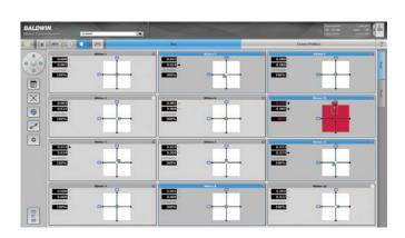
El registro de corte y plegado con MultiCam muestra todos los cortes y plegados a primera vista, y el sistema mantiene su tirada automáticamente dentro de las tolerancias establecidas.
