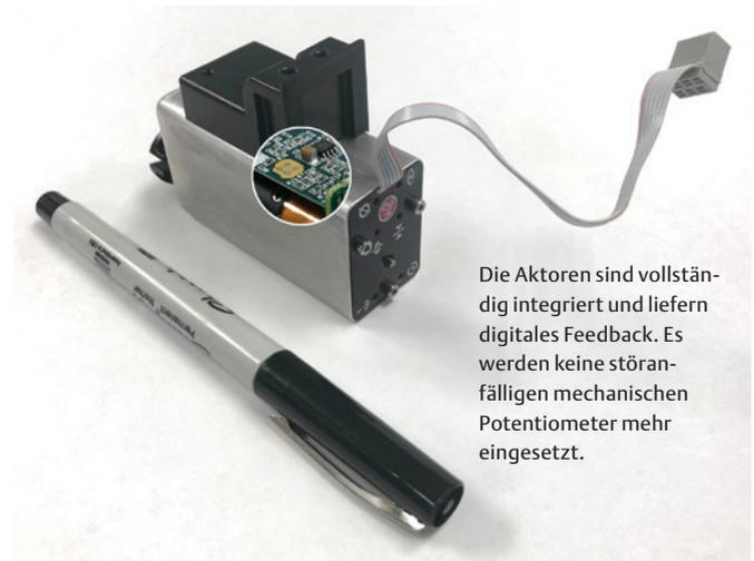
Die Aktoren sind vollständig integriert und liefern digitales Feedback. Es werden keine störanfälligen mechanischen Potentiometer mehr eingesetzt.
