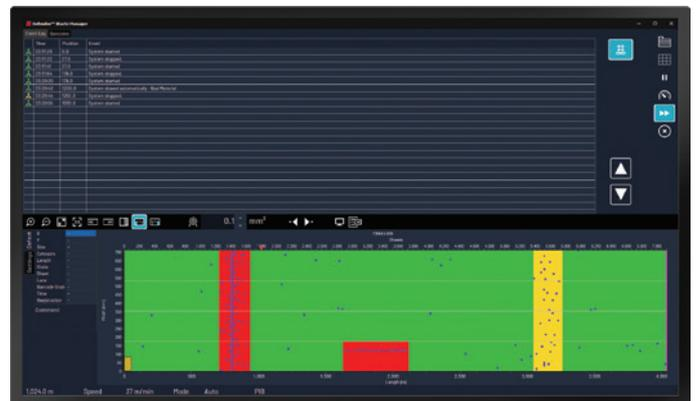
**Defender Waste Manager** puede interactuar con los equipos de rebobinado, corte y laminado para controlar de manera automática el momento en que deben detenerse/rechazar, a fin de eliminar en forma rápida y sencilla el material defectuoso.
