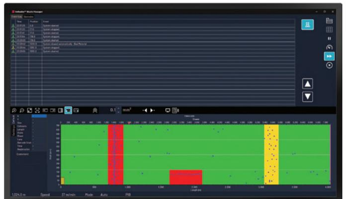
守护神废物管理系统可与收卷、分切和平张设备接口,自动控制何时停止/拒收,以便快速、轻松地清除有缺陷的材料。
