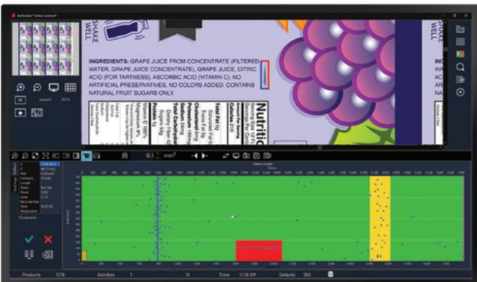
守护神数据中心系统为每一个已检查的卷筒材料建立可视图,以便质量控制操作人员能够分析缺陷分布、计数和类型。确定超出公差区域,以便清除,并且可以生成基于印刷的质量报告。
