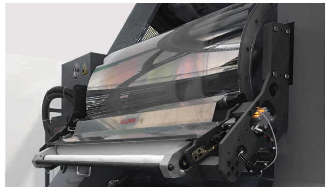
Installation eines FilmCylinderCleaners in einer Folienextrusionsanlage
